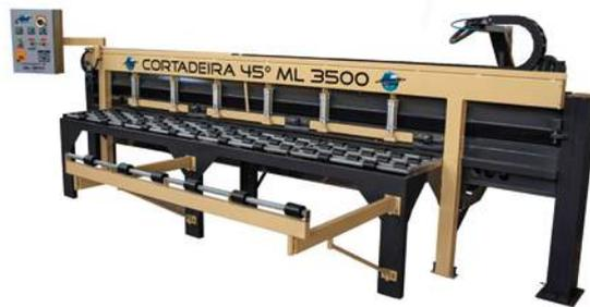
Corte 45°, estrutura em aço carbono e pintura em tinta epóxi, motor de 10cv, ajuste de velocidade para avanço e retorno, alcance máximo de corte de 3500mm, mesa extensora para largura máxima de corte de 2500mm, acionamento pneumático dos cilindros, sistema pneumático de lubrificação, bomba periférica, coletor de água e resíduo e parafusos em aço inox. Produção de até 5.000 metros lineares por mês.
