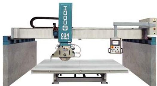
Com grande produtividade, a C34 R-MAX faz cortes em qualquer ângulo, com o movimento do cabeçote giratório a 364° e os eixos interpolados, consegue realizar cortes em placas de pedras naturais e artificiais com precisão e agilidade. Cortes a meia esquadria. O disco pode-se posicionar automaticamente em 0° ou 47° de forma pneumática. A mesa inclina-se por meio de sistema hidráulico para carga do material.
