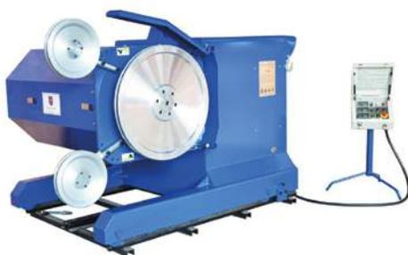
O Tensionamento do fio é controlado automaticamente pelo Inversor de Frequência. Processo de Corte pode ser controlado manualmente se for necessário. Movimento de Rotação da Cabeça de Corte, é feito por um motor com proteção limitadora de posição.
