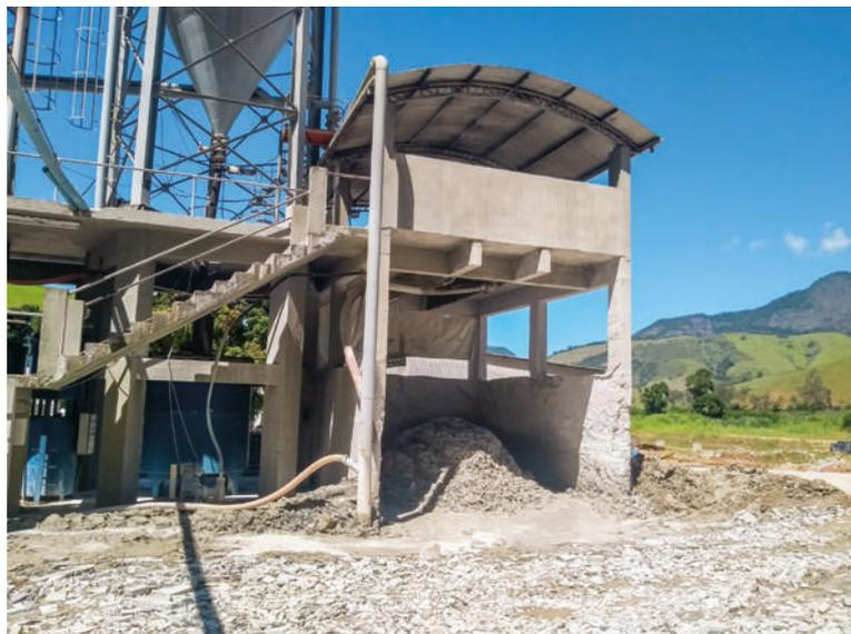
RESÍDUO DE ROCHAS ORNAMENTAIS APÓS PASSAR PELA RETIRADA DE UMIDADE NO FILTRO PRENSA NA EMPRESA CAJUGRAM, MIMOSO DO SUL – ES, EMPRESA QUE CEDEU O RESÍDUO PARA OS TESTES INDUSTRIAIS NA CIMACO.
