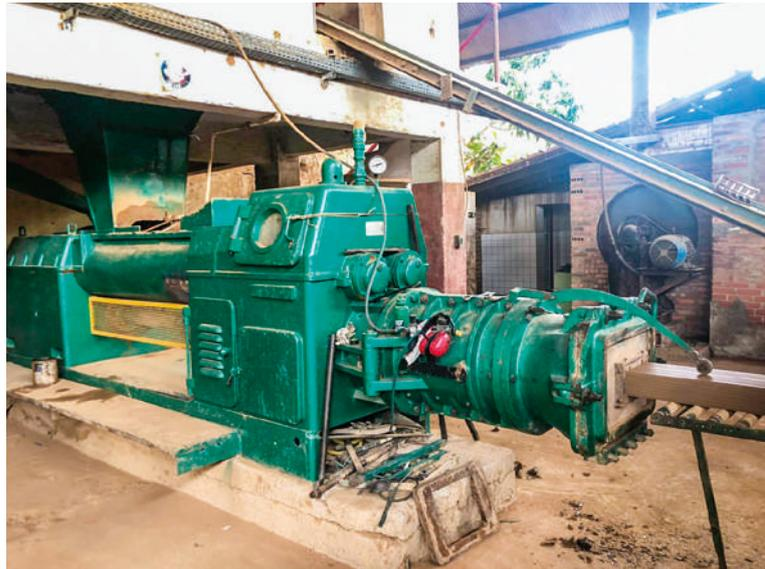
TESTE INDUSTRIAL NA CERÂMICA CIMACO NO MUNICÍPIO DE ITAPEMIRIM-ES, EQUIPAMENTO DE MISTURA E EXTRUSÃO DE ARTEFATOS CERÂMICOS.
